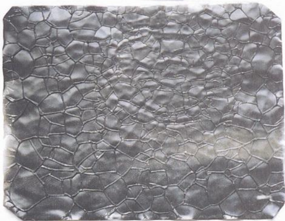
Abb. 8: Die Bildschicht des Röntgenbildes ist stark verworfen, wodurch die Information kaum mehr lesbar ist
