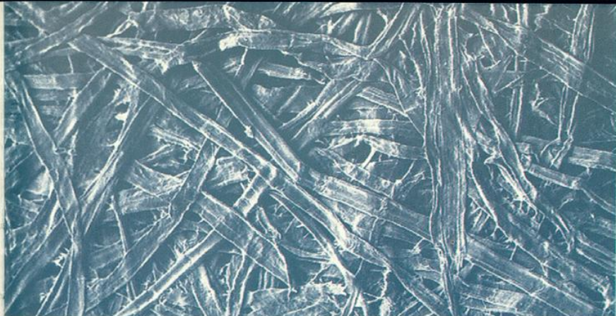
Rasterelektronenmikroskopische Aufnahme von Zellulosefasern in einem Papierblatt (reines Zellstoffpapier)
