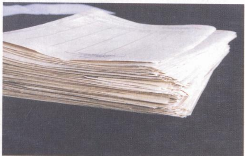
Abb. 10: Dokumente aus Abb. 9 nach der Entsäuerung im Flüssigverfahren sowie Stabilisierung und Entfernung von Klebstoffträgern
