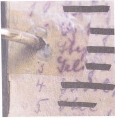
Abb. 3: Auswandernder violetter Farbstoff unter einem transparenten Klebeband
